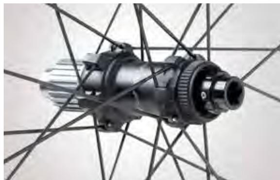
I mozzi X-Graff in AL 7075 - T6 supportano una vasta gamma di compatibilità, inclusi SH MicroSpline, HG, XDR e N3W. Cuscinetti Miche® in acciaio garantiscono grande scorrevolezza. Raggi 12+12 Light aero per una ruota dal un peso totale di 1600 grammi.
