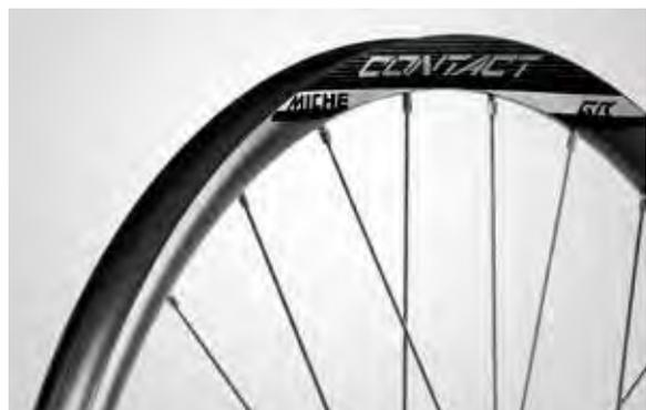
Cerchio con sezione interna 24mm e profilo da 24,5mm, Tubeless ready per l'utilizzo di pneumatici da 35mm a 50mm : il profilo asimmetrico garantisce il perfetto bilanciamento dei carichi.
