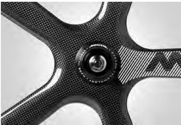
La attenta e precisa laminazione delle fibre di carbonio UD e 3K del cerchio Supertype SPX5 genera una ruota dalle caratteristiche di rigidità ed aerodinamicità uniche nella categoria, diventando quindi l'ottima scelta per tutte le prove contro il tempo. I mozzi in AL 7075 - T6 vengono assemblati con cuscinetti ceramici ad alta scorrevolezza per ridurre al minimo gli attriti ed ottimizzare ogni singolo watt espresso dal Pistard.
