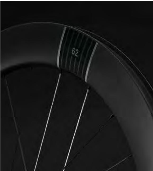
La grafica ufficiale del Groupama - FDJ Cycling Team veste anche le Kleos RD 62 Team, la nostra ruota pensata per la pura velocità. Progettata per spingere forte in ogni condizione, la Kleos RD 62 nasce da uno sviluppo guidato dai principi dell'aerodinamica. Il cerchio in fibra di carbonio Toray T1000/T700, con sezioni differenziate e canale interno da 23 mm, è compatibile con coperture copertoncino e tubeless, garantendo massima affidabilità e sicurezza su ogni terreno.
