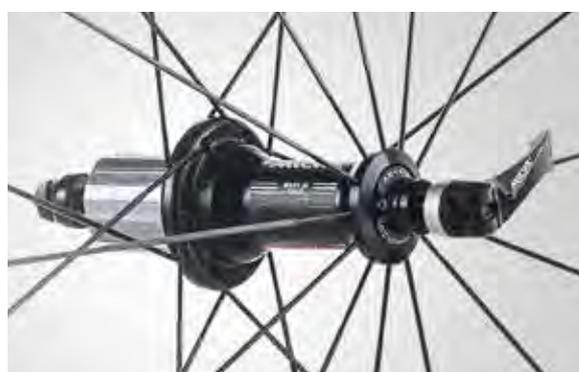
Corpo mozzo in AL 7075 - T6, lavorato a CNC. Il movimento è supportato da cuscinetti ad alta precisione a pieno riempimento di grasso per garantire la massima scorrevolezza nel tempo. Registrazione movimento mozzo semplificata - anche a ruota montata - attraverso un'apposita ghiera.
