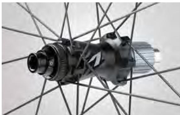
I nuovi mozzi in AL 7075 - T6 supportano diverse compatibilità, tra cui SH MicroSpline e XD, mentre i cuscinetti EZO® oversized da 30mm assicurano una rotazione fluida ed estremamente precisa. Raggi 12+12 SP DB Ultralight. Queste ruote sono progettate per dominare qualsiasi percorso off-road, garantendo sempre durabilità e affidabilità in ogni situazione di guida.
