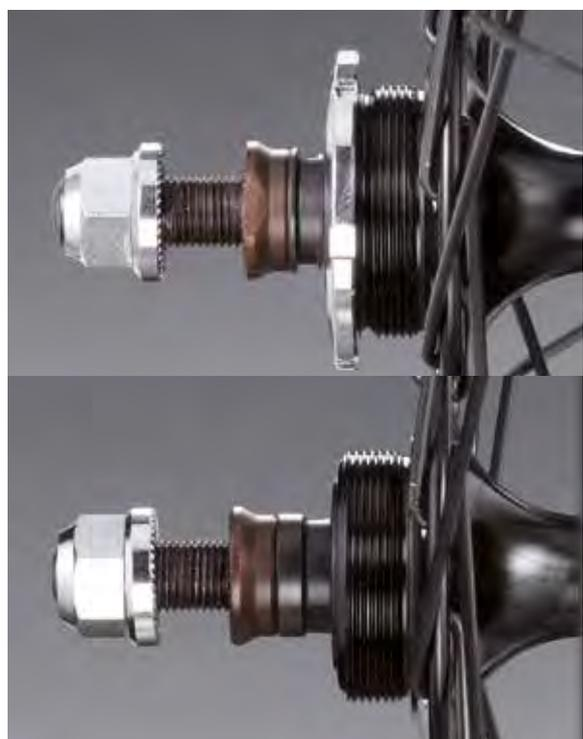
Mozzo Xpress con corpo in lega leggera forgiato a doppio filetto per pignone fisso e ruota libera, lavorato CNC ed anodizzato. Il movimento è supportato da cuscinetti ad alta precisione a pieno riempimento grasso che garantiscono protezione e scorrevolezza.
