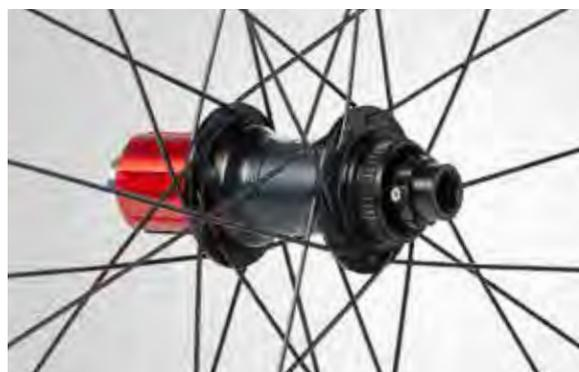
Mozzi Boost in alluminio forgiato e lavorati a CNC progettati con profilo conico a flangia media per una migliore performance e leggerezza. Registrazione movimento mozzo anteriore e posteriore - anche a ruota montata - attraverso un'apposita ghiera.
