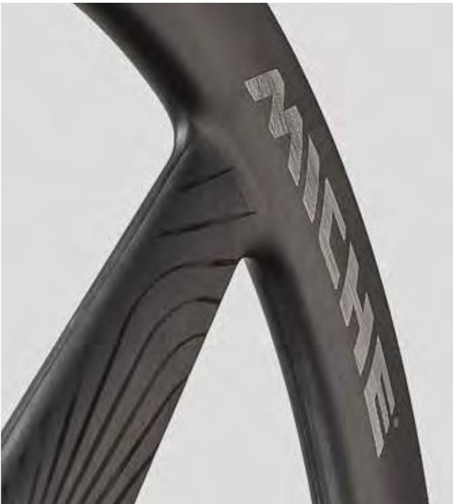
Ruota a tre razze realizzata in fibra di carbonio T 800 UD / T700 UD per garantire un equilibrio perfetto tra leggerezza e resistenza. Larghezza interna di 21mm con mini hook TC, è compatibile con sistemi tubeless. Il peso di 860 grammi assicura un'ottimale combinazione di leggerezza e robustezza. Ideale per le competizioni più esigenti. Le ruote sono state testate in galleria del vento per garantire le migliori performance in termini di aerodinamicità.
