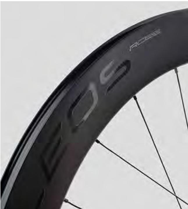
La ruota ad alto profilo è il simbolo di velocità. Attraverso analisi guidate dalle leggi dell'aerodinamica abbiamo costruito le Kleos RD 62. Il cerchio in fibra di carbonio Toray T1000/T700 adotta una struttura a sezioni differenziate ed un canale interno da 23 mm: sicurezza e massima affidabilità con tutte le coperture copertoncino e tubeless presenti sul mercato.
