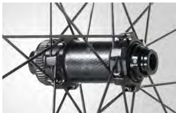
I mozzi in AL 7075 - T6 lavorati a CNC sono disegnati per una raggatura incrociata 12+12 ed assemblati con cuscinetti ad alta scorrevolezza per garantire le migliori performance. Registrazione movimento mozzo semplificata - anche a ruota montata - attraverso un'apposita ghiera. Per la chiusura del rotore disco utilizzare solo ghiera per perno passante con foro interno da 27 mm.
