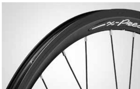
Cerchio in lega di alluminio 28mm con sezioni rinforzate per garantire migliore resistenza nell'utilizzo single-speed e commuting. Finitura full black e pista frenante finemente rettificata a CNC per frenate sicure e modulabili.
