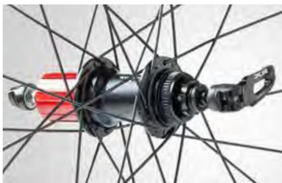
Mozzi in alluminio forgiato e lavorati a CNC progettati con profilo conico a flangia media. Il pattern di raggiatura 28 incrociato garantisce le migliori performance per l'utilizzo e-bike. Registrazione movimento mozzo semplificata anche a ruota montata.
