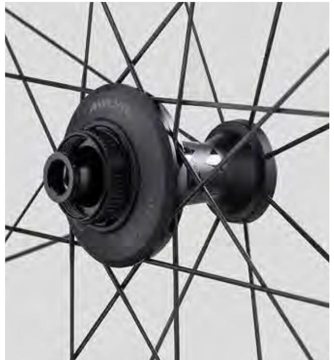
I raggi in acciaio inox a doppio spessore disposti secondo lo schema 16+8 incrociato/radiale prevedono sezioni aero differenti tra ruota anteriore e posteriore. Una innovazione messa a punto a seguito dei dati raccolti in galleria del vento. Un ambiente che ha permesso di creare il cupolino Aero Blade che ottimizza il flusso aerodinamico attorno alla flangia del mozzo anteriore.
