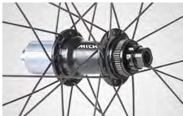
Mozzi in alluminio forgiato e lavorati a CNC progettati con profilo conico a flangia media per una migliore performance e leggerezza. Registrazione movimento mozzo anteriore e posteriore - anche a ruota montata - attraverso un'apposita ghiera. Per la chiusura del rotore disco utilizzare solo ghiera per perno passante con foro interno da 27 mm.
