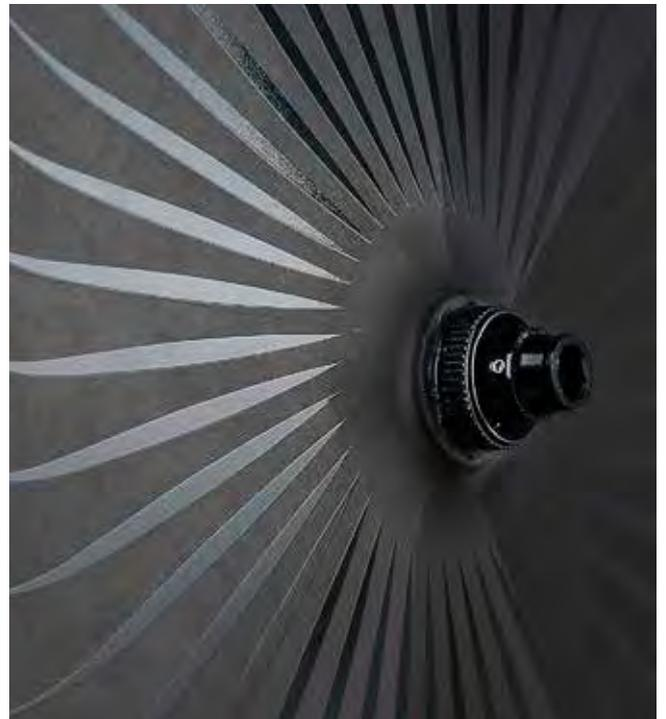
Il mozzo RRT è costruito in AL 7075 - T6 lavorato CNC montato con cuscinetti CeramicSpeed® e provvisto di ghiera di registro. Il corpo ruota libera in AL 7075 - T6 con componenti in titanio è disponibile per compatibilità con tutti i sistemi di trasmissione Shimano® HG, Campagnolo® UD, N3W e SRAM® XDR.
