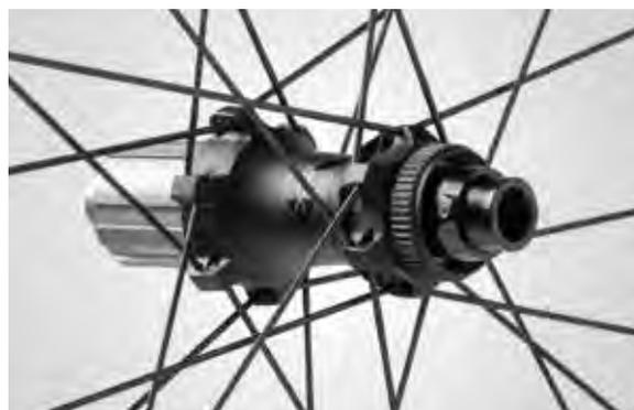
I nuovi mozzi CX in AL 7075 - T6 supportano diverse compatibilità, da SH MicroSpline a HG, XDR e N3W, mentre i cuscinetti SKF® garantiscono una fluidità di rotazione impeccabile. Raggi 12+12 Superlight doppio spessore aero completano il pacchetto tecnico. Con un peso complessivo di 1445 grammi, queste ruote sono pronte a rivoluzionare le tue avventure gravel.
