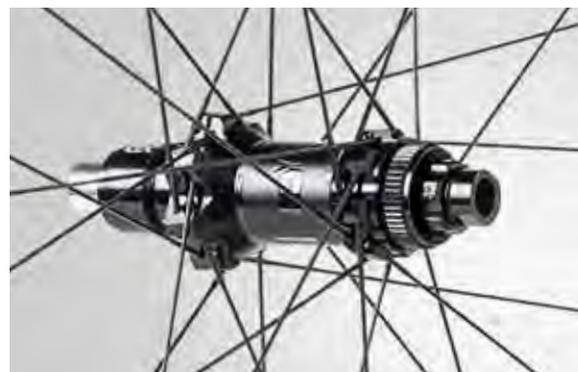
I mozzi in AL 7075 - T6 lavorati a CNC sono disegnati per una raggiatura incrociata 14+14 ed assemblati con cuscinetti ad alta scorrevolezza per garantire le migliori performance. Registrazione movimento mozzo posteriore attraverso un'apposita ghiera.
