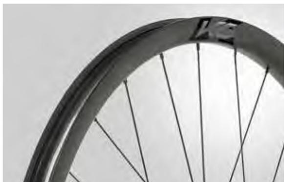
Nuovo cerchio in fibra di carbonio UD ad alto modulo, profilo Hookless asimmetrico con sezione interna maggiorata da 30 mm ed altezza da 25 mm.
