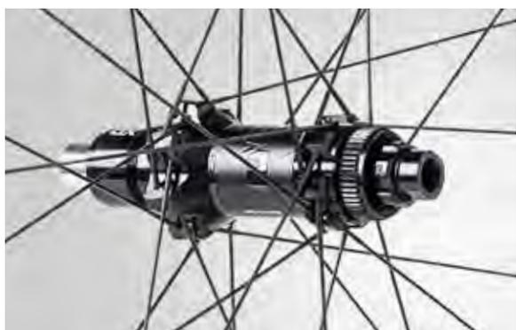
I mozzi in AL 7075 - T6 lavorati a CNC sono disegnati per una raggiatura incrociata 14+14 e assemblati con cuscinetti ad alta scorrevolezza per garantire le migliori performance. Registrazione movimento mozzo posteriore attraverso un'apposita ghiera.
